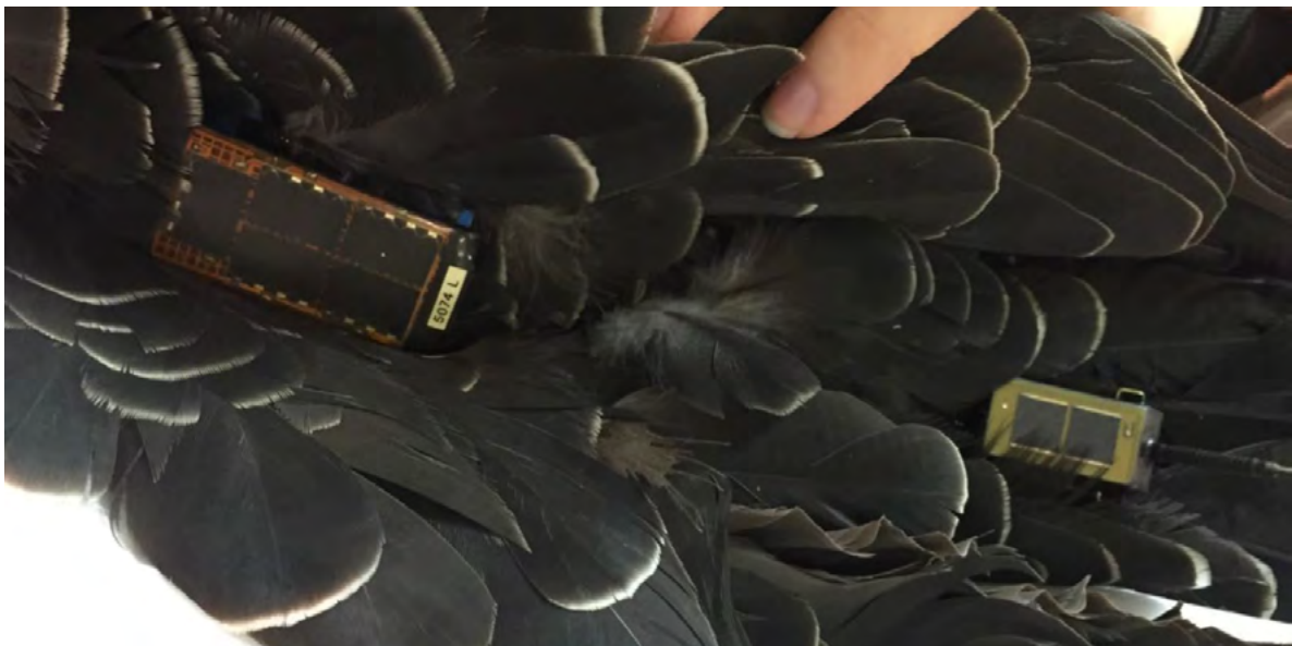
Transmisor satelital adherido a la parte superior de las plumas centrales de la cola y marca GPS adherida a las plumas traseras de una cacatúa fúnebre piquicorta.
